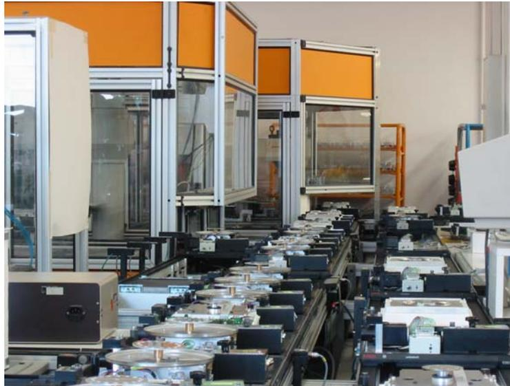
Komplettmontage der Waagen an einem Arbeitsplatz – große Mengen- und Variantenflexibilität
